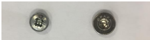
Kannan muodot (vanha ruuvi ja uusi ruuvi)
