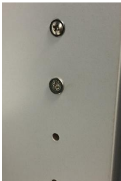
Kannan muodot (vanha ruuvi ja uusi ruuvi)
