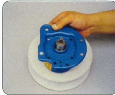
14. Irrota voimantuottopuolen runkokehys vastaavalta akselilta.
