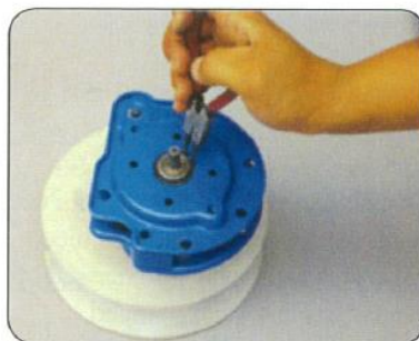
7. Irrota lukkorengas syöttöpuolen runkokehyksestä.
