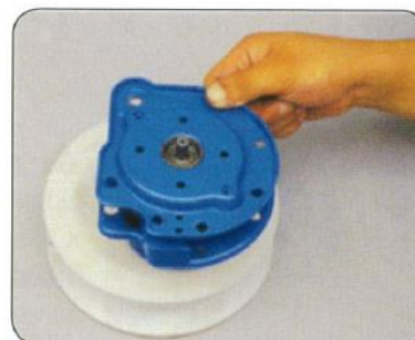
8. Nosta syöttöpuolen runkokehys irti voimantuottoakselilta.
