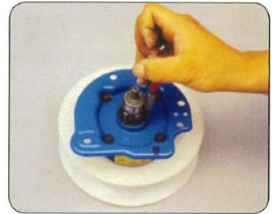
12. Irrota lukkorengas, joka lukitsee voimantuottopuolen runkokehyksen vastaavalle akselille.
