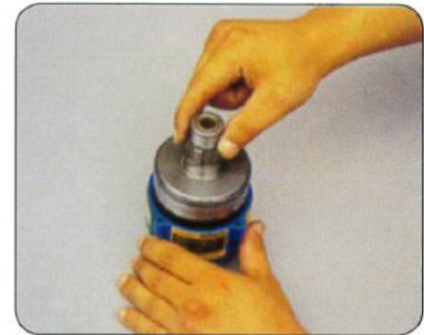
15. Irrota voimantuottoakseli sisäisestä vaihteistokotelosta.
