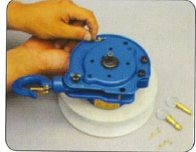
3. Poista läpiviennin ja puristintelakotelon lukitustapit ja sokat.
