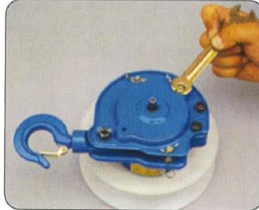
2. Irrota rungon kansi syöttöpuolelta (2 pulttia).
