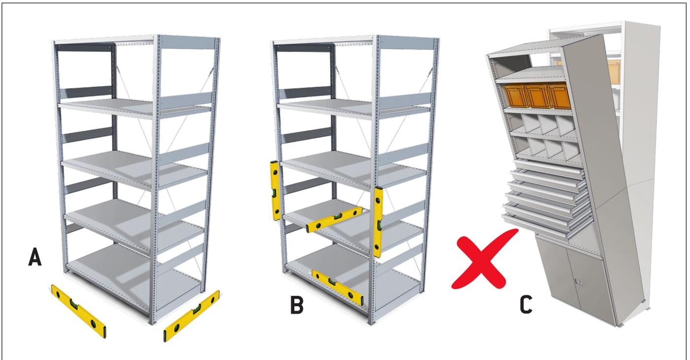
Figura 14 Pavimento di appoggio, livellamento e fissaggio
