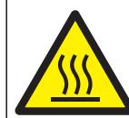
Forbrenningsfare fra varme overflater!
