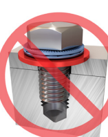
Kosketuspinnat on oltava lukittuna paikalleen
